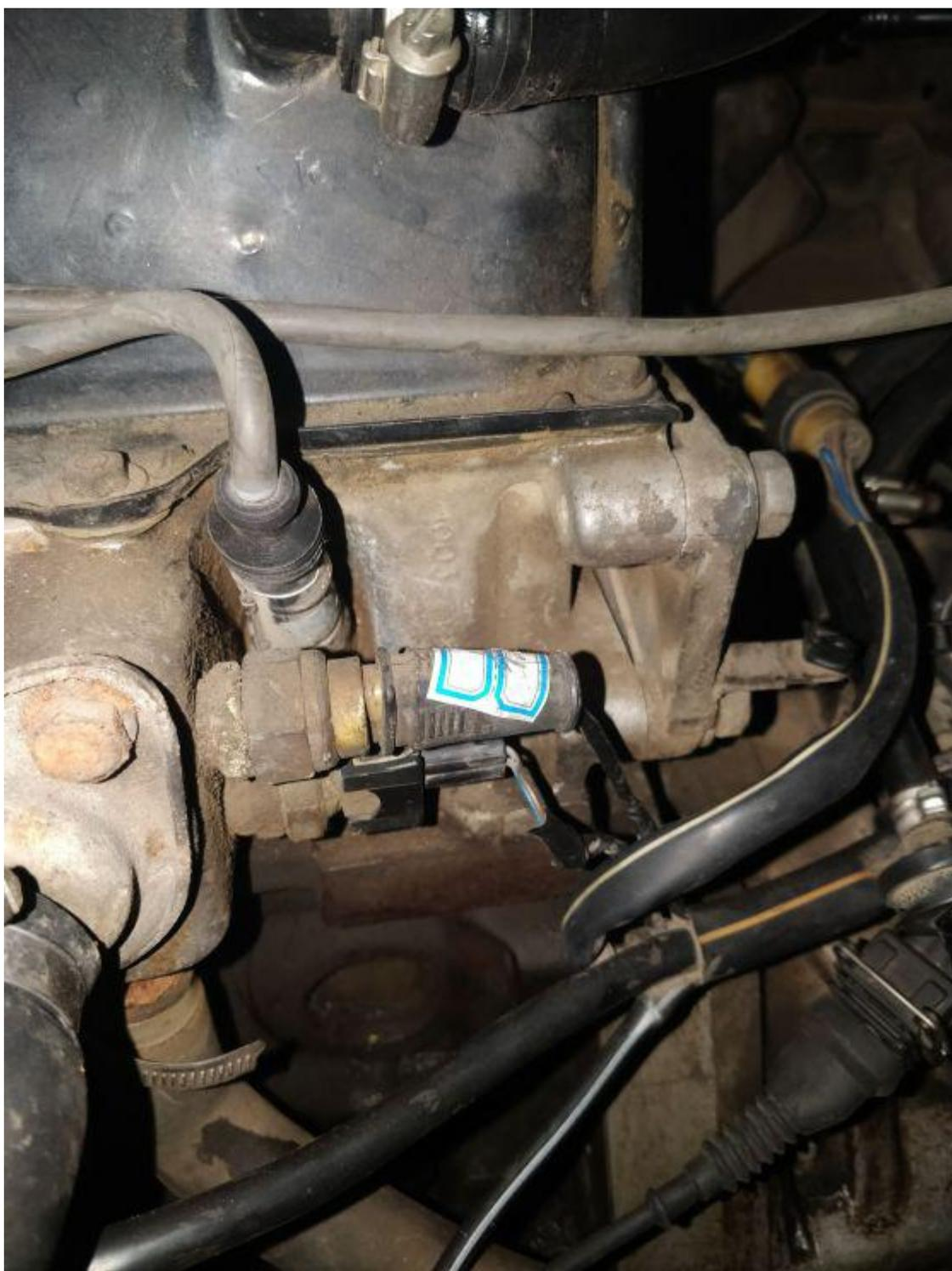
然后是把发动机上的各个位置固定螺丝松开拿下来，发动机部分被两个银耳结构固定在了车架上，银耳上面有一个螺母，下面有两个，把银耳拆下来了。变速器的固定在扭力梁上，前面已经卸下来了。
